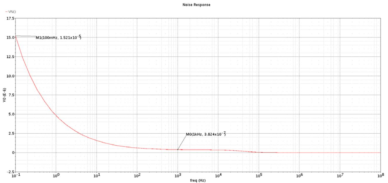
图 8. 基准源输出噪声电压功率谱密度
