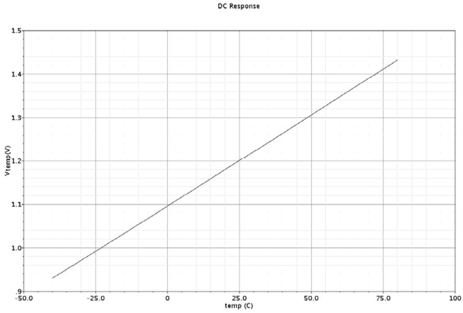
图 9. 温度传感器输出电压随温度变化
