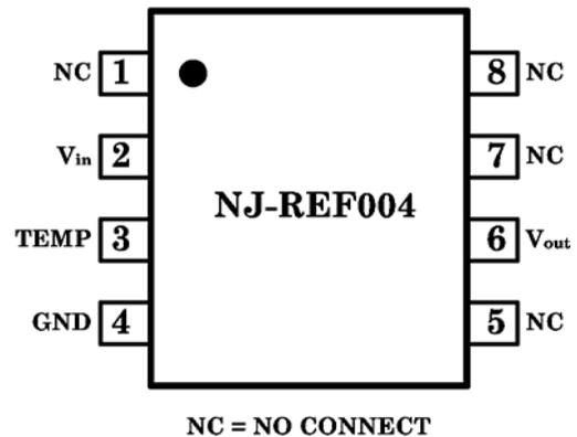
图 1. 基准电压源电路引脚图【SOP8】
