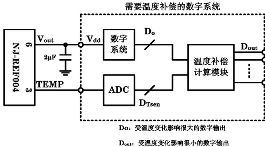
图 17. 基准电压源在数字系统中的应用
