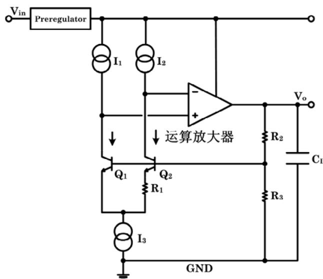
图 13. 基准源电路原理图
