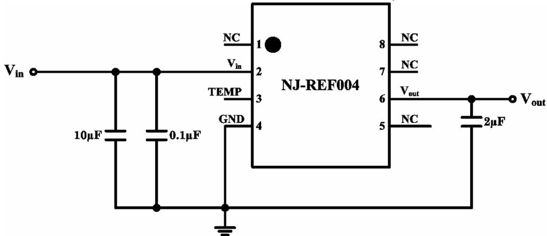
图 15. 基准源应用电路连接图
