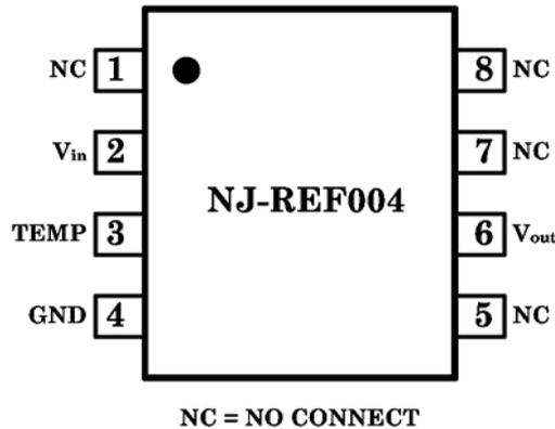
图 2. 基准电压源电路引脚图 【SOP8】
