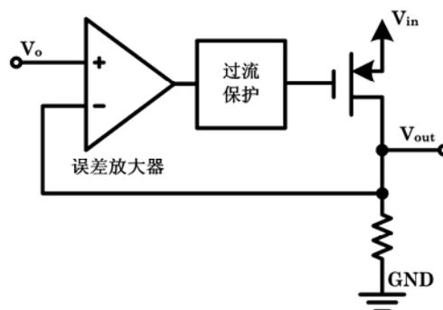
图 14. 输出缓冲器电路原理图
