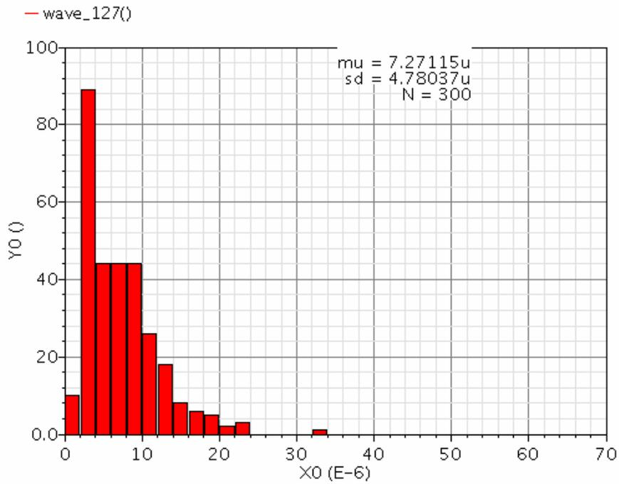
图 5.基准源温度系数分布，横坐标为温度系数【ppm/°C】，纵坐标为样本个数
