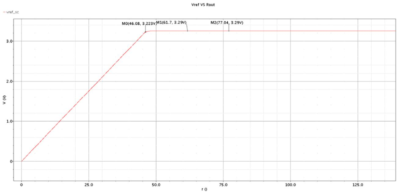
图 12. 过流保护电路工作下的输出电流。可以发现最大输出电流约为 70 mA，即负载电阻为 46  $\Omega$ 。当负载电阻小于该值时，电路输出电压将下降以保证输出电流恒定。
