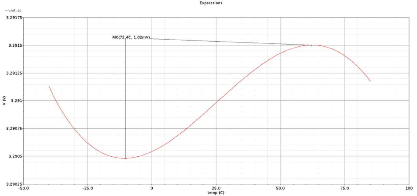
图 3. 基准源输出电压随温度变化
