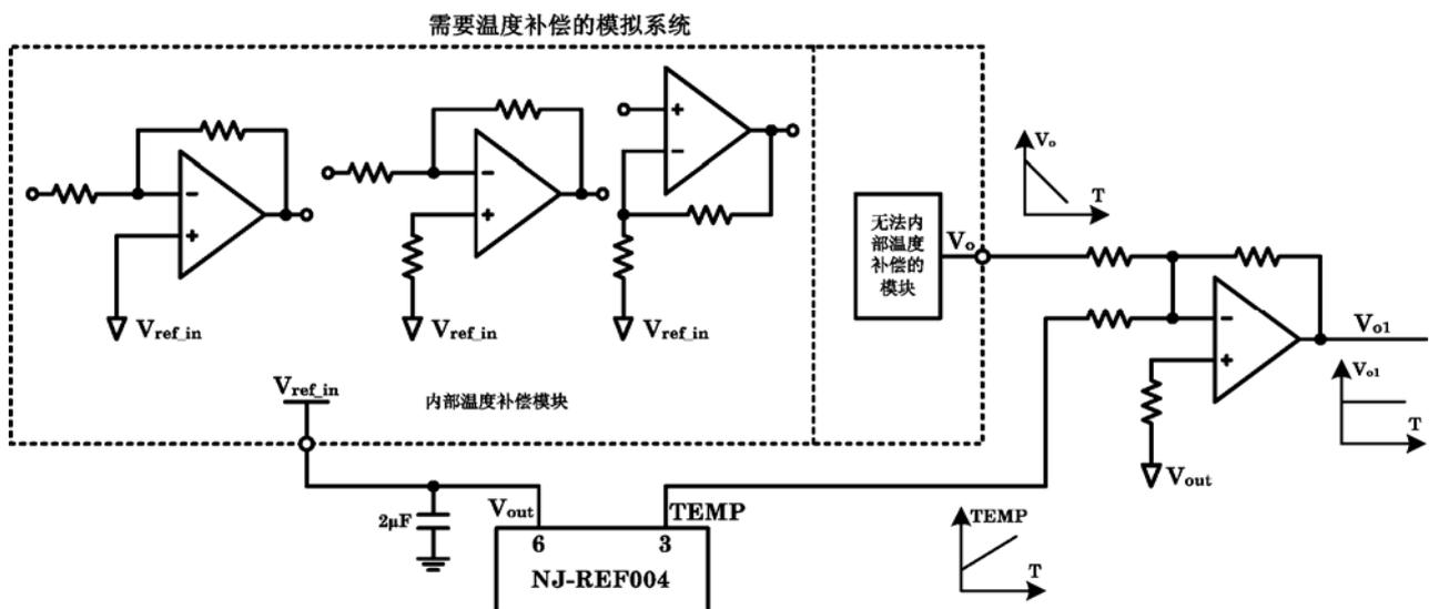
图 16. 基准电压源在模拟系统中的应用
