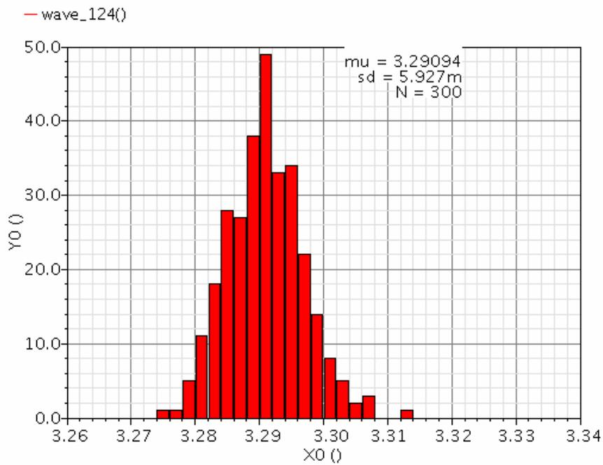
图 6. 基准源输出电压分布，横坐标为输出电压【V】，纵坐标为样本数量
